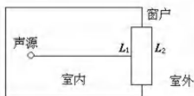
图 6.10-1 室内声源等效室外声源图例
